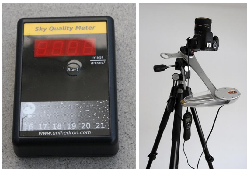
Obrázek 1: přístroj Sky Quality Meter (vlevo), fotografická sestava pro měření jasu noční oblohy (vpravo). Zdroje: vlastní snímek a Michal Bareš (poskytnuto autorem).
